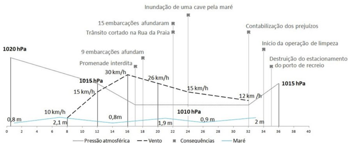
Fig. 5. Sucessão dos acontecimentos, desde as 00.00h do dia 10-12-2013 às 13.00h do dia 11-12-2013 do galgamento costeiro na cidade de Santa Cruz.
