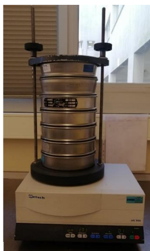
Figura 4 – Agitador de peneiros com a sequência vertical de crivos utilizada na caracterização granulométrica.
