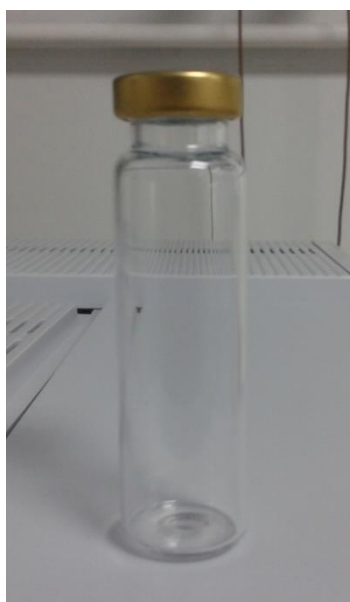
Figura 19 - Recipiente usado para cromatografia gasosa com um cromatógrafo GC-2010 Plus.
