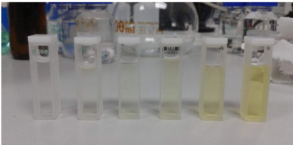
Figura 21 - Soluções padrão para análise UV-Vis, com concentrações de 0 mg/l; 0,75 mg/l; 1,5 mg/l; 3 mg/l; 7,5 mg/l e 15 mg/l .
