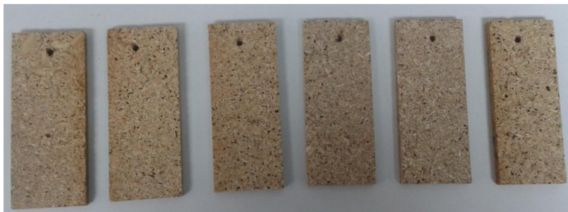
Figura 17 - Amostras de aglomerado de madeira usadas para ensaios, com as dimensões especificadas na norma.
