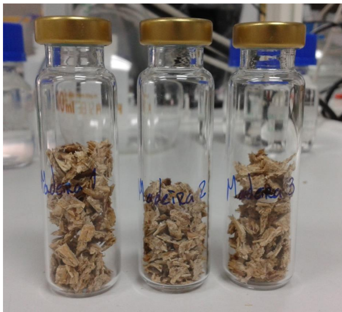
Figura 20 - Amostras ensaiadas de aglomerado de madeira com peso, respetivamente, de 1,9997 g; 1,9997 g e 1,9996 g.
