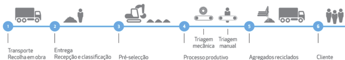
Figura 4 - Processamento do RCD para reciclagem num operador licenciado [24].
