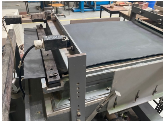
Figura 41 - Aspecto final da instalação da GMB sobre a base rígida.
