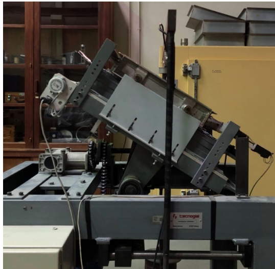
Figura 32 - Equipamento de ensaio de corte em plano inclinado do LMC da FEUP.
