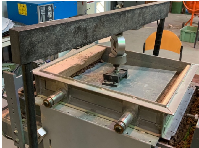
Figura 64 - Afundamento do RCD (GC = 55%, W_{ót} ): resistência ao corte do RCD.
