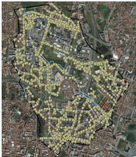
Fig. 4.5 – Câmaras de visita da rede de drenagem, retirado do Arcgis Pro com informação disponibilizada pela empresa Águas do Porto.
