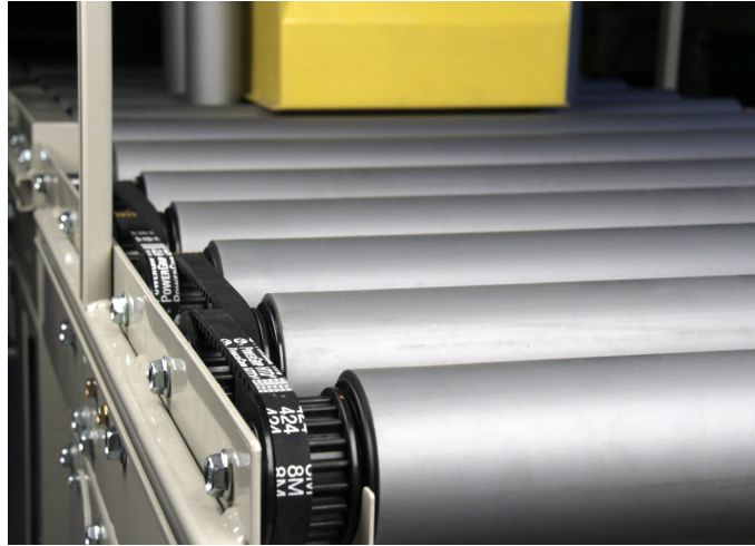
Figura 2.3: Acionamento por correias dentadas de um transportador de rolos, nontagem “rolo-a-rolo” [11].
