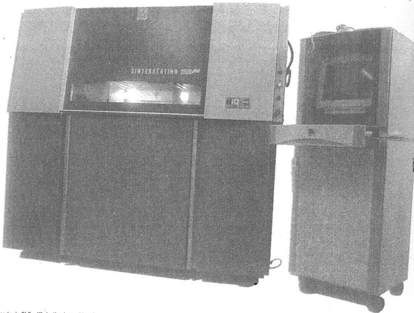
Maquinária de SLS - "Selective Laser Sintering". Processo Aditivo de Prototipagem Rápida.
