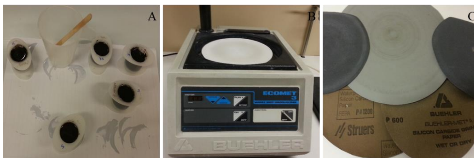
Figura 11 Preparação de blocos polidos: A) Exemplo do processo utilizado nos blocos polidos; B) Equipamento de polimento; C) Lixas utilizadas no polimento.
