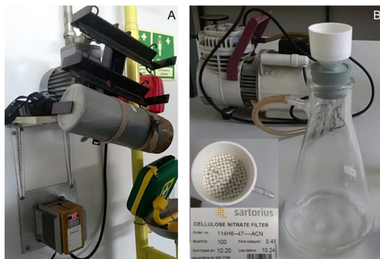
Figura 12 Equipamentos utilizados nos ensaios de lixiviação: A) Tambor rotativo do tipo topo-base utilizado; B) Método de filtragem utilizado e exemplo de um filtro após filtração de uma amostra lixiviada.
