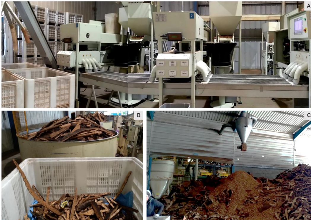
Figura 4 Seleção de matéria-prima: A) Sistemas análise de imagem de última geração para seleção de discos de cortiça de elevada qualidade; B) Placas de cortiça rejeitadas no processo produtivo; C) Pó de cortiça rejeitado durante o processo produtivo.
