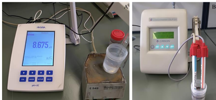
Figura 8 Equipamentos para medição de pH e condutividade elétrica: A) Medidor de pH; B) Medidor de condutividade elétrica.
