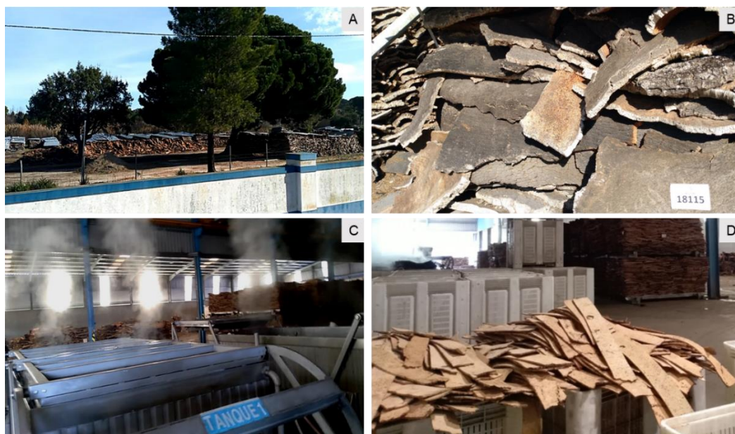
Figura 3 Processo de amadurecimento da cortiça e de produção das placas: A) Local de amadurecimento da cortiça ao ar; B) Identificação do lote de cortiça para controlo do tempo de amadurecimento e controlo de qualidade; C) Tanque de cozedura das placas de cortiça; D) Placas de cortiça de elevada qualidade para a produção dos discos de cortiça.
