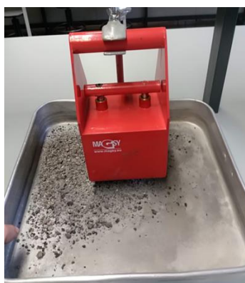
Figura 17 Processo de separação magnética manual aplicados às CPC.
